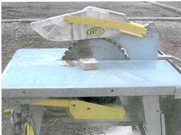
Abb. 1: Ältere Baustellenkreissäge mit hochgestellter Schutzhaube (Foto: BG BAU)
