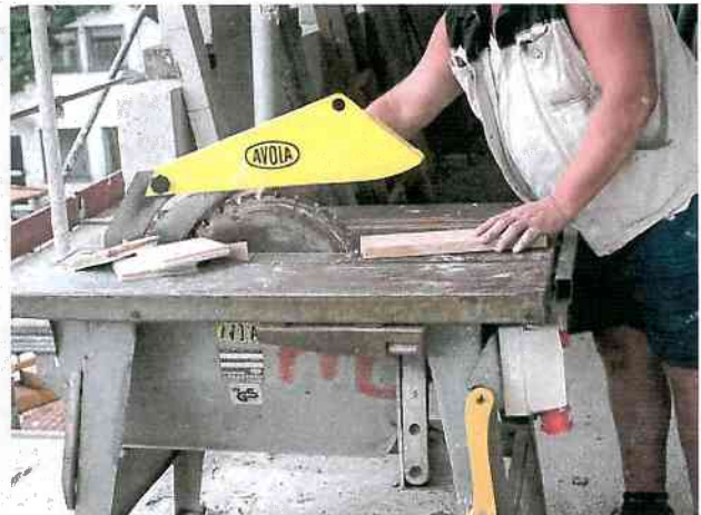
Abb. 2: Nachgreifen mit der rechten Hand, um Holzreste zu entfernen (Foto: BG BAU)
