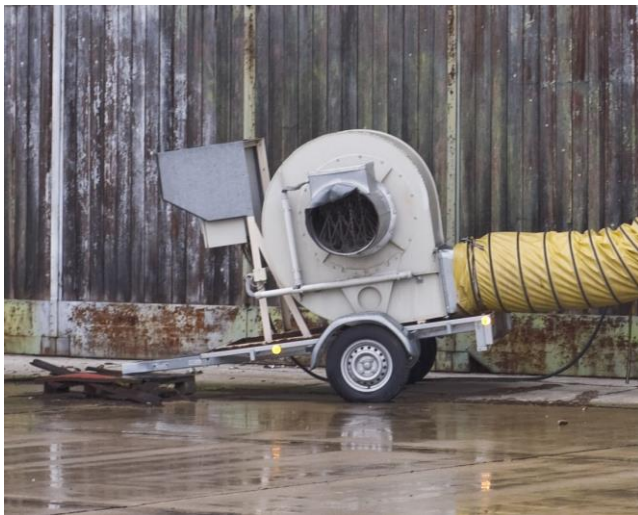
Bild 2: Ventilator, ca. 10.000m 3 /h
