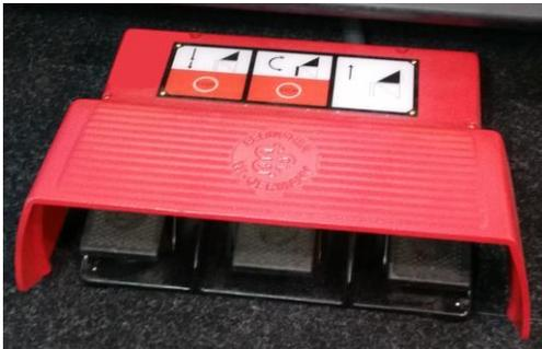
Bild 16: Beispiel 3-pedaliger Fußschalter
