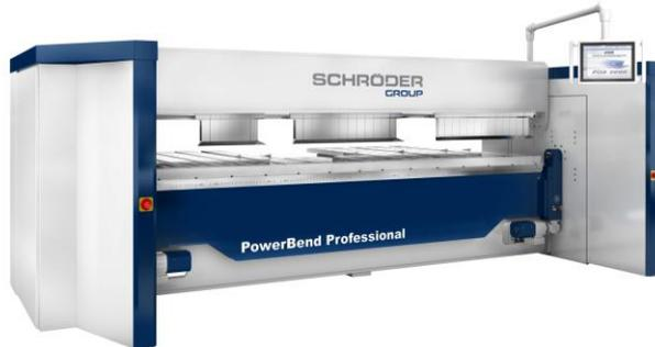
**Bild 9:** Beispiel Schwenkbiegemaschine mit Not-Halt-Taster an den beiden Maschinenständen (links, rechts)
