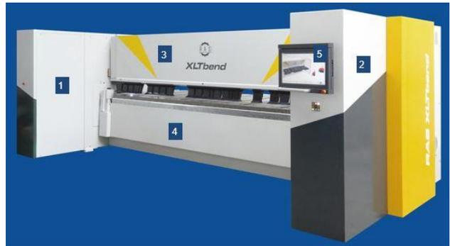
**Bild 4:** Beispiel Schwenkbiegemaschine mit segmentierter Biegeschiene (Vorderseite) an der Oberwange
