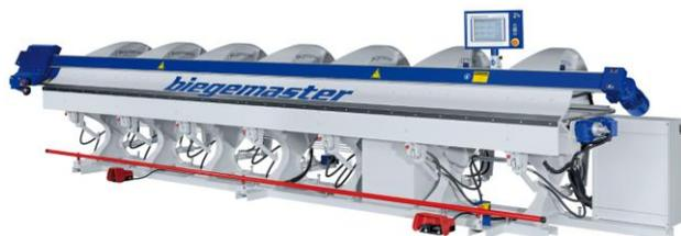
**Bild 7:** Beispiel Langabkantmaschine mit roter Not-Halt-Stange. (analog zu Bild 6)
