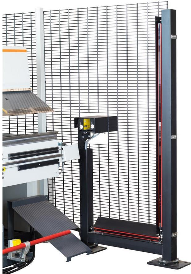
**Bild 14:** Beispiel Langabkantmaschine als Doppelbieger mit vertikalem und horizontalem Lichtvorhang als Zutrittsschutz und Hintertretschutz sowie Schutzzaun und Laserstrahlen (vgl. Kap. 3.1.4).
