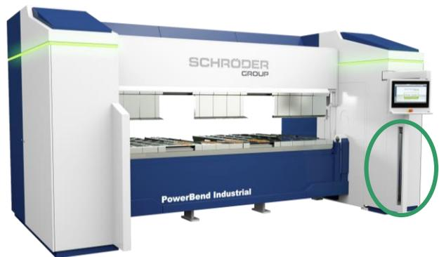
**Bild 12:** Beispiel Schwenkbiegemaschine, Vorderseite abgesichert mittels Lichtvorhang (grüner Kreis)
