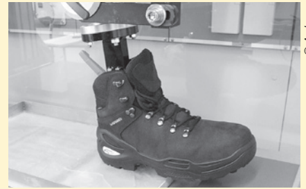
Abb. 3: Bestimmung des Gleitreibungskoeffizienten nach DIN EN ISO 13287, Verfahren A/C-Ferse-Vorwärtsgleiten
