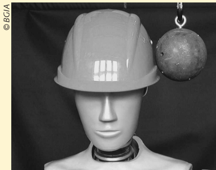
Abb. 2: Versuch zur seitlichen Festigkeit
