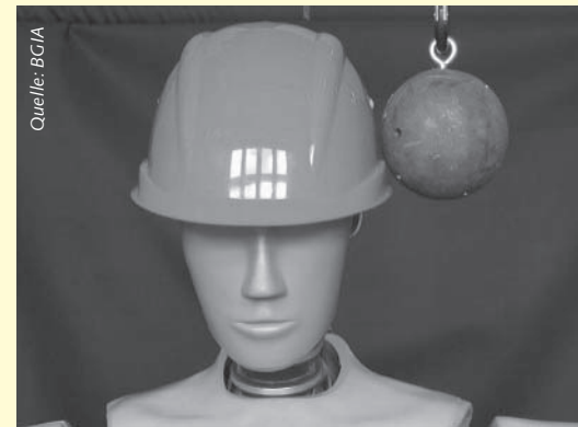
Abbildung 2: Messung mit Schutzhelm.
