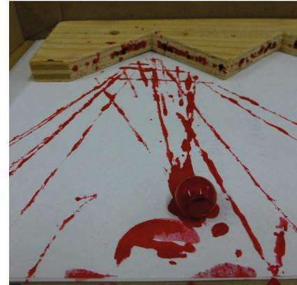
Abb. 4: Prinzip des Rückstrahlers im Zweidimensionalen
