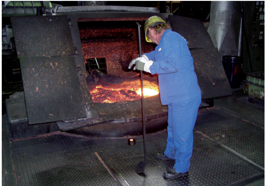
Bild 2 Exposition durch Wärmestrahlung (sichtbare und IR-Strahlung) bei der Arbeit an einem Metallschmelzofen.
