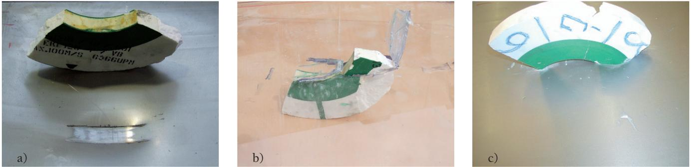
**Bild 4** Aufprallsituationen; Auftreffen mit der a) Umfangsfläche, b) Querschnittsfläche, c) Bohrungsseite.
