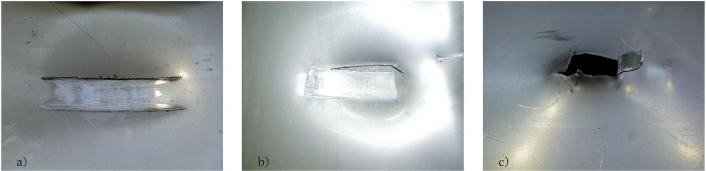
**Bild 2** Schäden an den Prüfmustern; a) Beulung, b) Anriss, c) Durchschuss.
