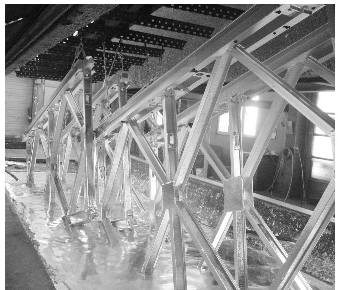
Bild 1. Entnahme verzinkter Werkstücke aus dem geschmolzenen Zink des Zinkessels.
