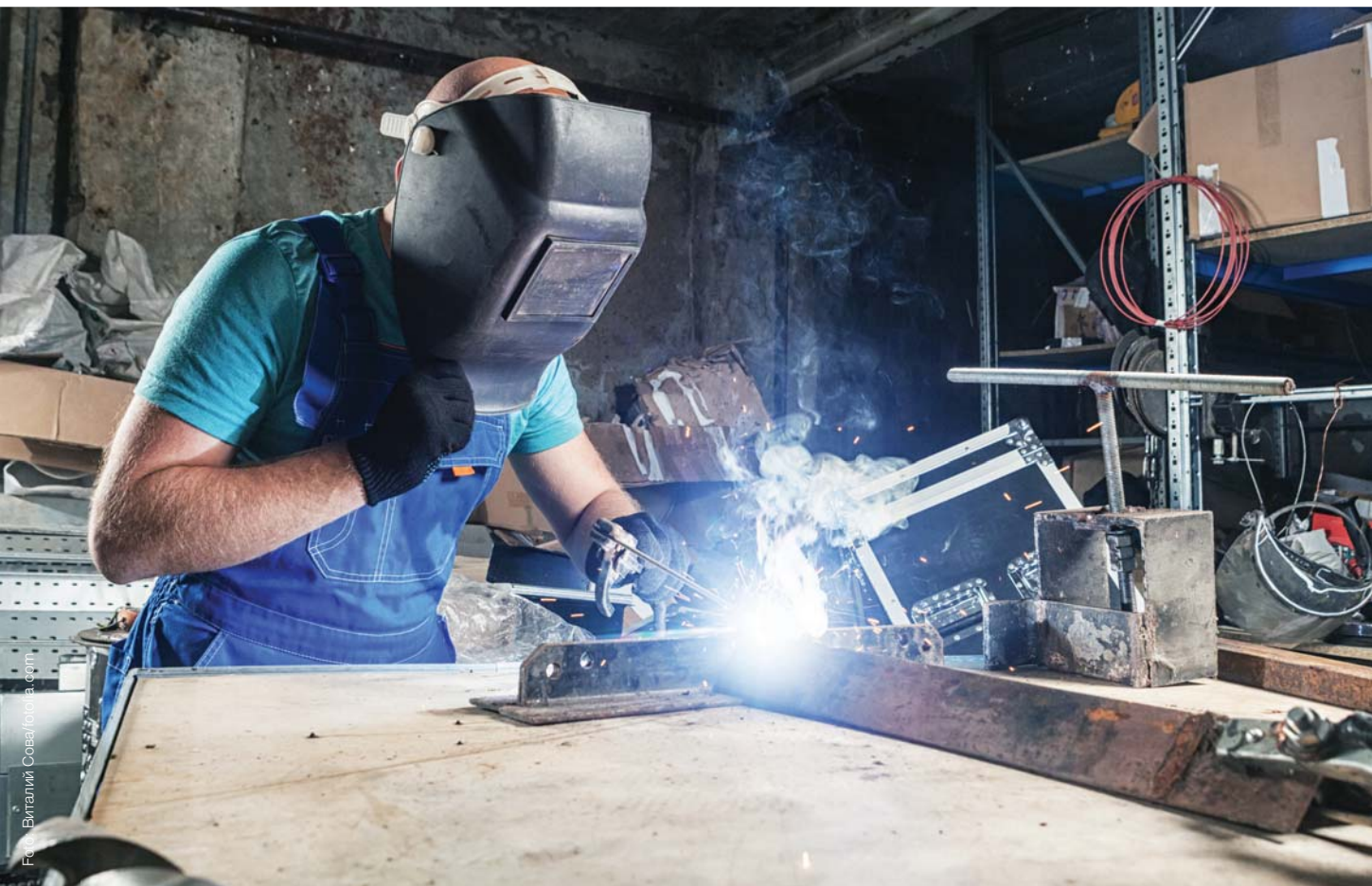
Beschäftigter beim Schweißen. Der Schutz insbesondere der Arme ist unzureichend, da schon bei Expositionen im Sekundenbereich Expositionsgrenzwerte überschritten werden.
