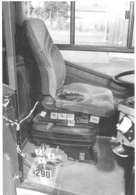
Abbildung 2: Lage und Befestigung der Meßscheibe am Meßpunkt Sitz und Befestigung der Beschleunigungsaufnehmer am Meßpunkt Chassis
