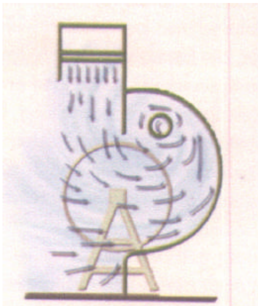
Abbildung 3: Funktionsweise des Wirbelsenkenverfahrens
