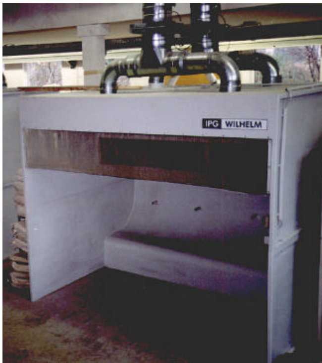
Abbildung 4: Schleifkabine nach dem Wirbelsenkenverfahren
