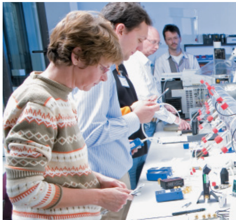
Probenahme an der Prüfgasstrecke bei einem Ringversuch im BGIA
