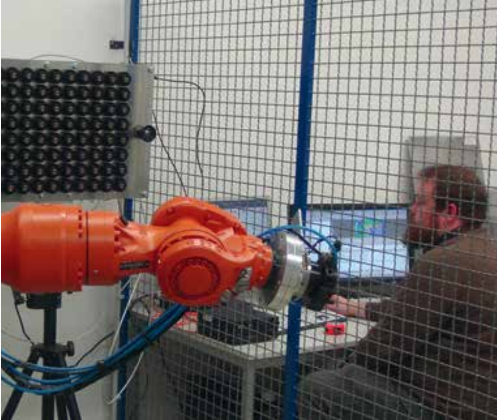
Abbildung 2: Feldtest des Detektionssystems mit einem Industrieroboter. Im Hintergrund des linken Bildes ist das aktive Nahinfrarotkameranaher System zu erkennen.
