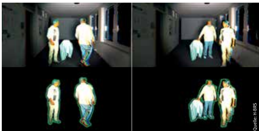
Abbildung 3: Personendetektion der Kamera, visualisiert durch grüne Umrisse: Im rechten Bild wird ein Gegenstand durch Berührung der danebenstehenden Person zugeordnet.
