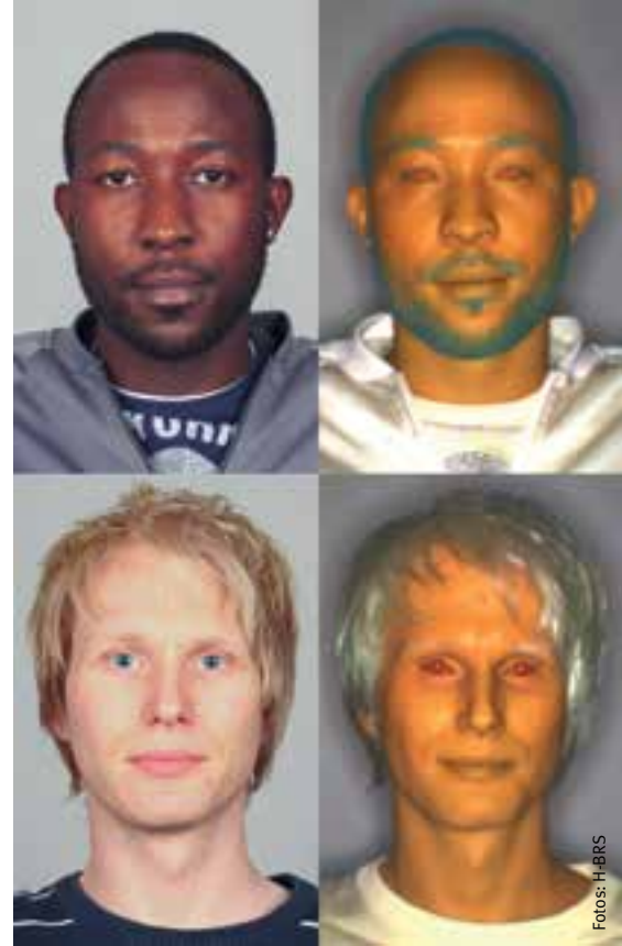
Abbildung 1: Aufnahme von Gesichtern unterschiedlichen Hauttyps mit einer üblichen Kamera (links) und in Falschfarbendarstellung mit einem Nahinfrarotsystem (rechts).
