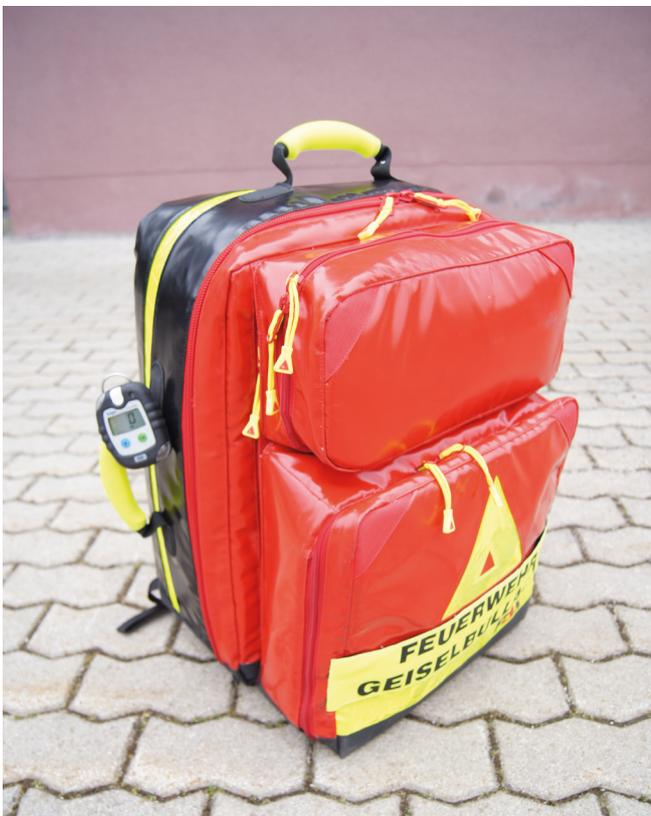
Die Kohlenmonoxid-Warngeräte sind dank moderner Technik sehr klein und können leicht an Kleidung oder Rettungsausrüstung befestigt werden. Bei Feuerwehrleuten zählen die Geräte häufig zur Grundausrüstung. Bei den Rettungsdiensten sind sie noch nicht flächendeckend Standard.
