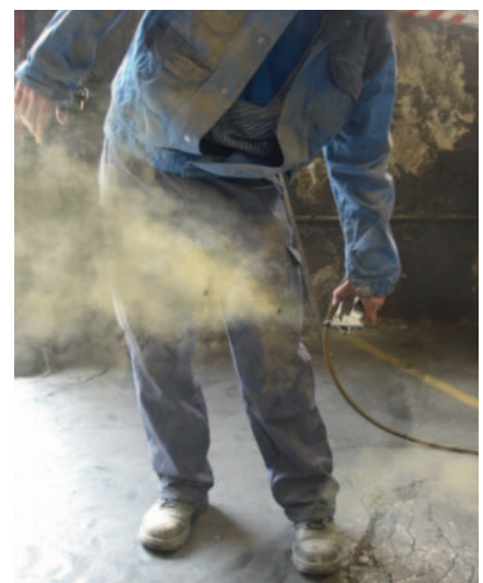
Verbotenes Abblasen mit Hilfe von Druckluft
