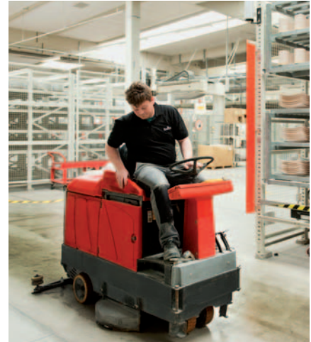
Die Beseitigung von Verunreinigungen muss so staubarm wie möglich erfolgen.
