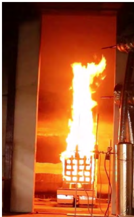
Abbildung 7 Versuchsraums mit einer brennenden UL 1715-Holzkippe 480 Sekunden nach Zündung
