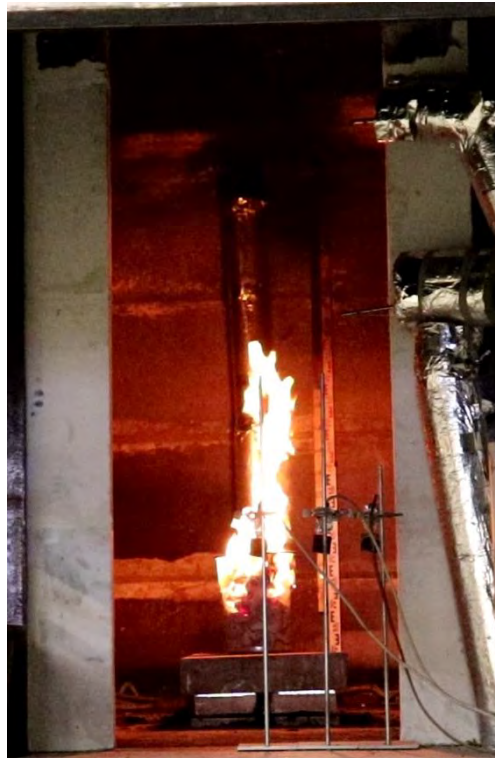
Abbildung 21 Versuchsaufbau mit einem brennenden Papierkorb 90 Sekunden nach Zündung
