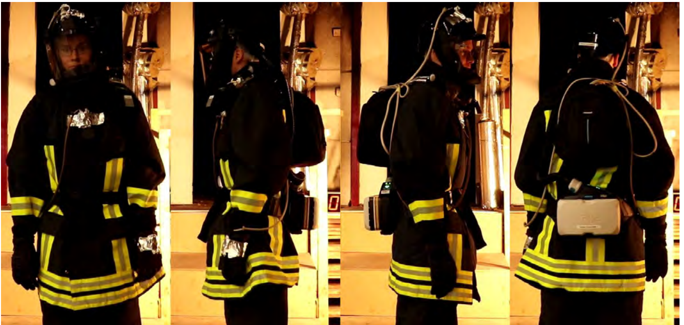
Abbildung 3 Personengetragene Messtechnik X-am 7000, X-am 8000 und Heatfluxsensoren Typ T sowie persönliche Schutzausrüstung des Bedieners der Feuerlöschgeräte
