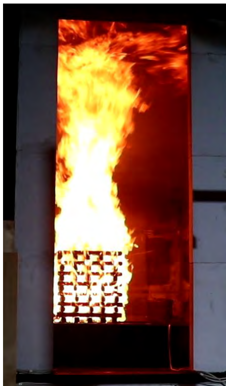
Abbildung 6 Versuchsraums mit einer brennenden 8A-Holzkippe 480 Sekunden nach Zündung
