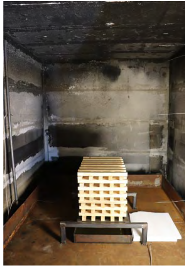
Abbildung 1 Versuchsaufbau mit einer Holzkrippe 8A, einer Brandwanne sowie einer umgebenden Stahlwanne im Room-Corner-Testraum
